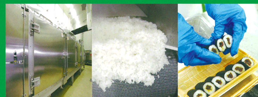
蒸気で炊飯するため、お米の表面が傷つくことなく風味がよくツヤのあるご飯が炊きあがる。大型の蒸気炊飯設備では、1時間最大約600キロの炊飯が可能。高い衛生・安全基準で品質管理にも注意を払っている。
