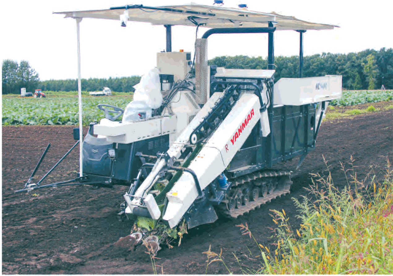
無人のキャベツ収穫機。カメラの画像をAIが判断しながら実を傷つけずにカットする。
